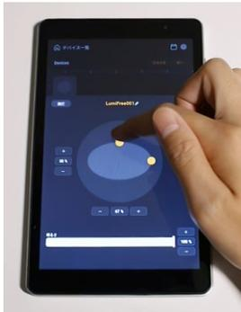
配光・明るさは、器具横のボタンで調整できます。または、オプションのタブレット型専用コントローラ (LC-TAB01) をご使用いただくと、より感覚的な配光・調光操作が可能です。専用コントローラでは、複数台を同期点灯させることや、好みの配光に瞬時に変更して点灯させることもできます。
