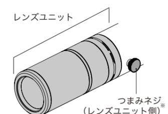
灯具本体に付いているつまみネジ(レンズユニット側)を緩めると、レンズユニットを回転させることができます。調整後はしっかり締め直してください。
