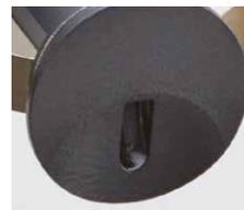
開口部の縦スリット形状により間接光の下面照射に。また、開口部の小口を薄くすることで、グレアレスな仕様になっています。目に優しい、夜間の目印灯として特化した構造です。
