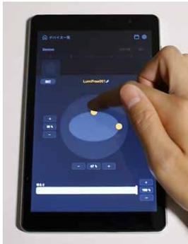
配光・明るさは、器具横のボタンで調整できます。または、オプションのタブレット型専用コントローラ (LC-TAB01) をご使用いただくと、より感覚的な配光・調光操作が可能です。専用コントローラでは、複数台を同期点灯させることや、お好みの配光に瞬時に変更して点灯させることもできます。
