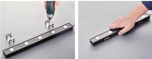
施工面にホルダをネジ止めした後に器具をはめ込んで取り付けます。取付部分が干渉するため、グレアカッターバーとの併用はできません。
