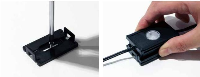
施工面にホルダをネジ止めした後に器具をはめ込んで取り付けます。施工面に適した3mm径のネジをご用意ください。
