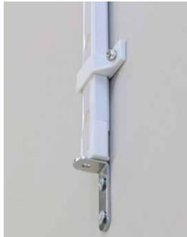
エンド側（リードコネクタの無い側）を下として、必ず市販のL字金具などで荷重受けを設け、別売の強力両面テープと取付ブラケットで固定してください。
