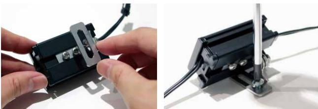
器具本体の所定位置にホルダをスライドさせネジ止めしてください。ホルダを取り付け後、施工面にネジ止めて固定します。調整範囲は±55°です。施工面に適した4～5mm径のネジをご用意ください。
