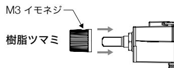
※つまみには、M3のイモネジが付属しています。工具は付属しません。六角レンチ（M3 対辺1.5mmで固定してください。）
