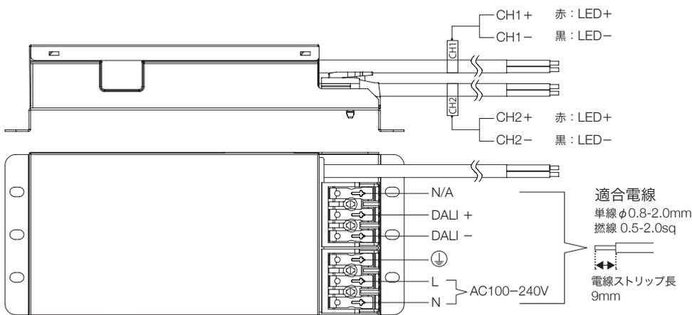
アース端子にアース線を接続し、D種(第3種)設置工事を確実に行ってください。
