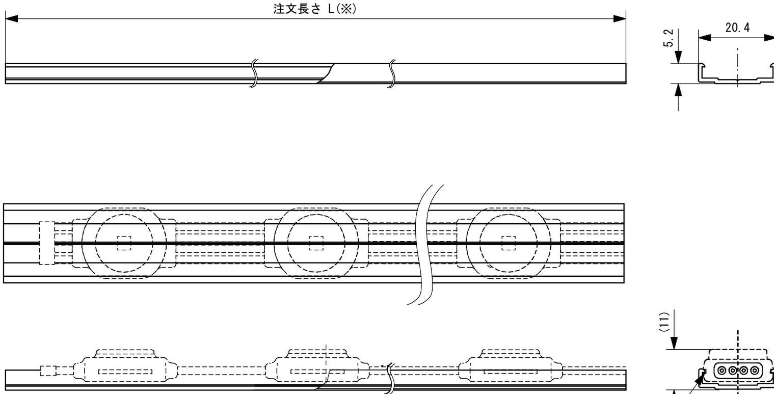
注) トリリ्यूーム本体両方の側面にある溝にマウントレールの爪を合わせてはめ込んでください。
