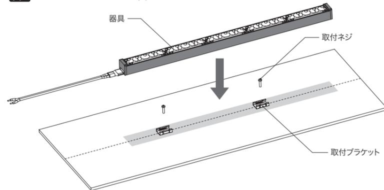
図3 縦向き壁付け施工する場合
