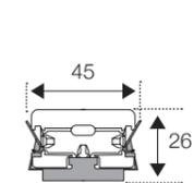
建物への設置の際は、固定ホルダのビス留め用穴を利用して設置を行ってください。施工面に適した4~5mm径のネジをご用意ください。
